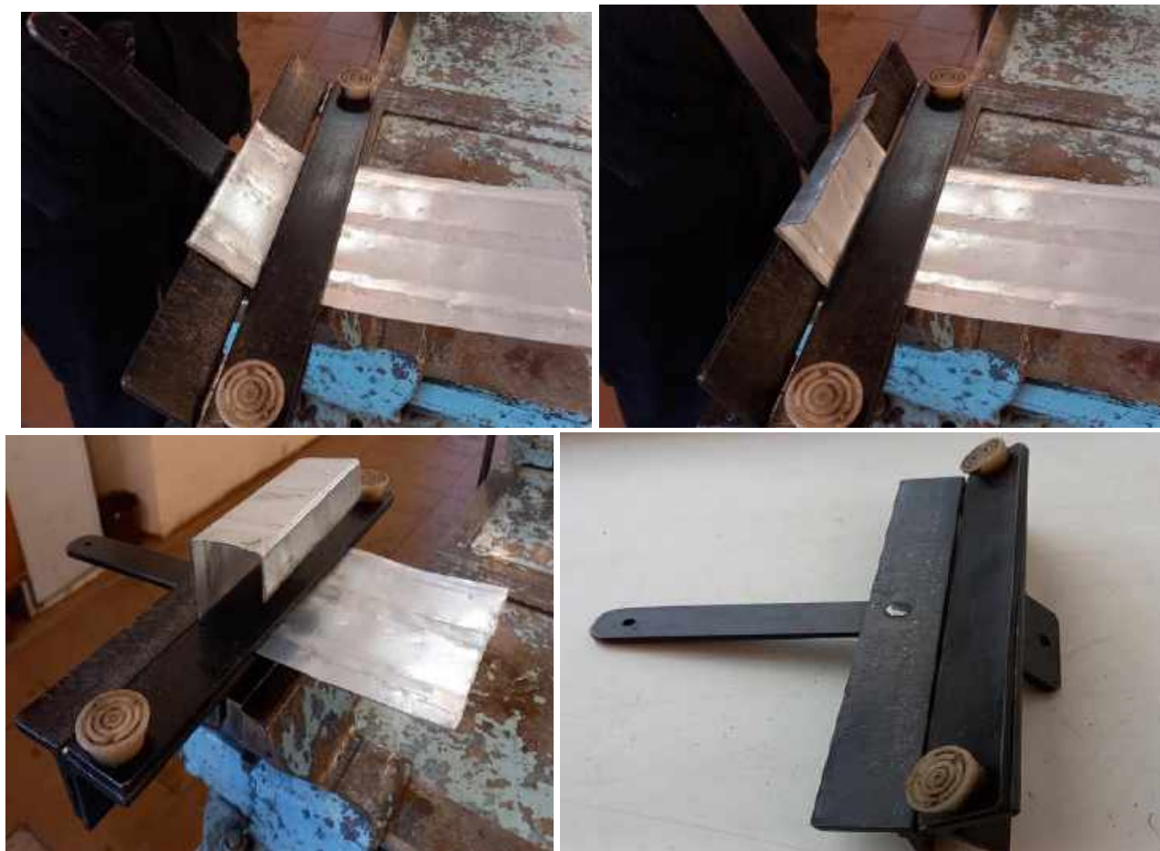
Рисунок 2- Процесс гибки листового металла
