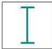
- металлическая колонна с фундаментом
