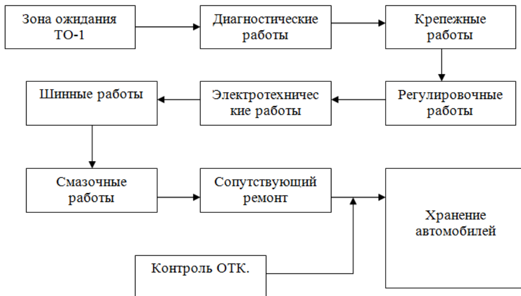
Рисунок 1. Схема технологического процесса технического обслуживания автомобилей в зоне ТО- 1
